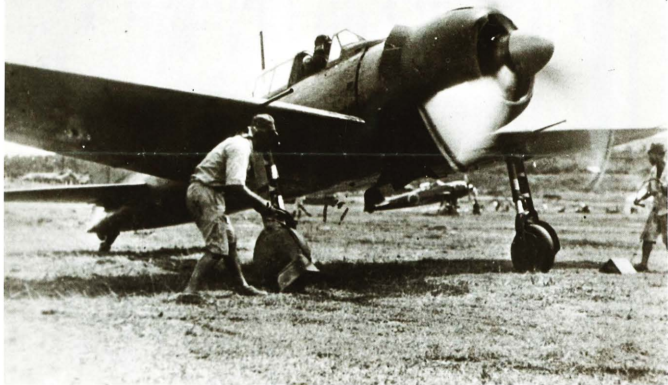
翼内の20mm機銃を長銃身の99式2号3型に換装した零式艦上戦闘機22型甲(A6M3a)。
